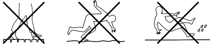
Figur 6: Belægninger med fuger, ujævne samt glatte belægninger accepteres ikke.
